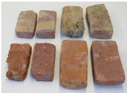
Afb. 13a-c Bakstenen uit de oudste stadsmuur (98CAN910): a. links vier kleinere bakstenen uit poer 5M (21/22 x 10,5/11 x 4,5/5 cm) en rechts de grotere soort bakstenen uit alle poeren (26/27 x 12,5/14 x 6/7 cm), ruw gevormd en de voorste zacht en de achterste te hard gebakken; b. bakstenen met een inkeping, de bovenste dubbel ingekeept; c. baksteen met ingekrast kruisteken
